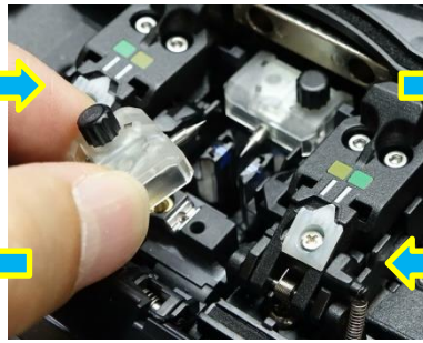
Instale los nuevos electrodos
